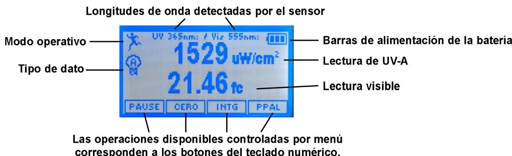
Emita la luz directamente sobre el sensor de interés (UV o VIS) en el detector doble. El medidor leerá y mostrará al instante el nivel de luz de cada longitud de onda (intensidad/área de unidad).
