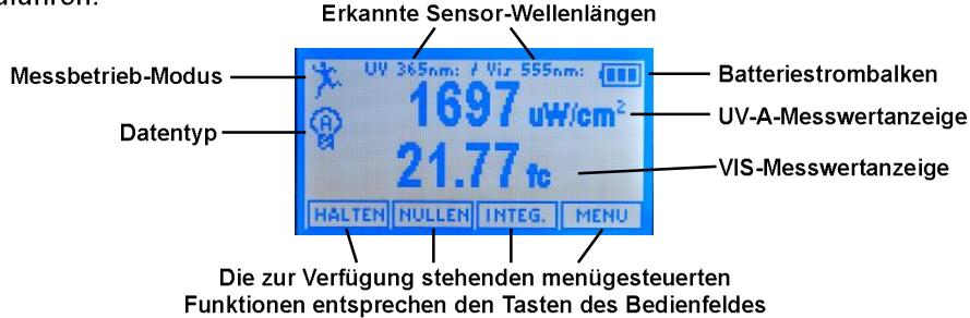
Lassen Sie das Licht direkt auf den Sensor auf dem Dual-Detektor, der von Interesse ist (UV oder VIS) einfallen. Das Messgerät führt umgehend eine Messung des Lichtniveaus durch und zeigt das Lichtniveau für jede der Wellenlängen an (Intensität/Flächeneinheit).
